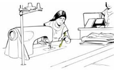
3. 缝纫工人用磁棒检查自己的工位。
