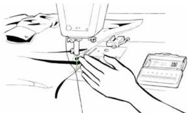
1. 缝纫工人从缝纫机中取出机针的后半部，从缝线上取下机针的前半部。
