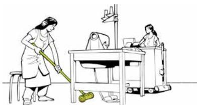
5. 缝纫工人用磁铁扫把寻找桌子下面的断针碎片。
