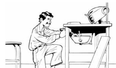
8. 机械师在缝纫机和油槽中寻找断针碎片。
