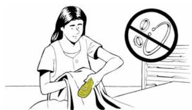
6. 缝纫工人用手持扫描仪先在最后缝纫的位置上寻找，然后在整件衣服上寻找。
