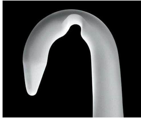
针钩内弧的磨损 (未涂层)
