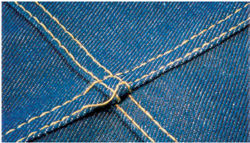
Fehlstiche – vor allem beim Übernähen von Quernähten
