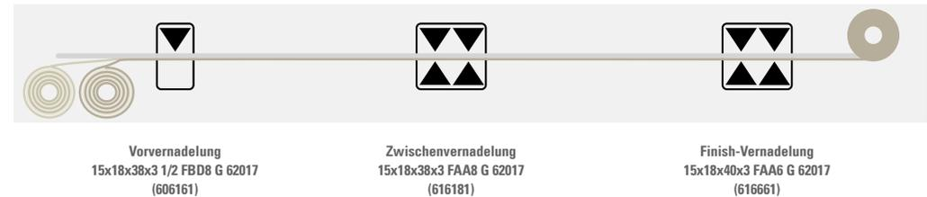
Filznadeln mit tropfenförmigem Arbeitsteilquerschnitt und HL-Kerben im gesamten Vernadelungseffekt ermöglichen eine Herstellung von Produkten mit höchster Faserschonung und geringster Trägermaterialbeschädigung.
