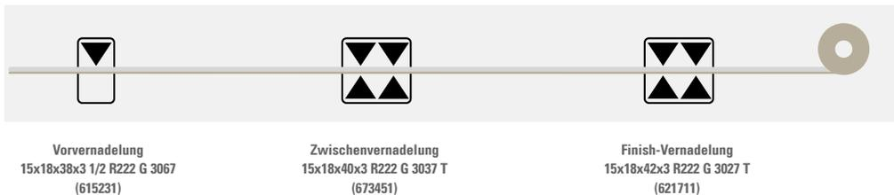
Bedingt durch das verdrehte Arbeitsteil einer Twisted-Filznadel sind die Kerben definierter im Einsatz. Die Folge ist eine effizientere Zwischen- und Finish-Vernadelung, zudem sind dadurch höhere Produktionsgeschwindigkeiten möglich.
